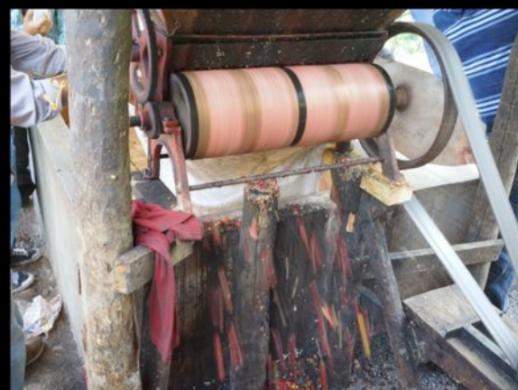
手摘みした上の写真のコーヒーチェリーをさらにソーティング（選別）します。選別後にはじかれたチェリー（写真左下）。写真 右下の機械は果肉除去をするものです。
